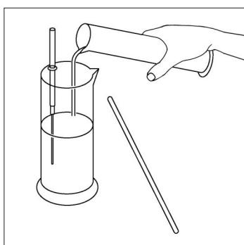
Pour préparer la solution de révélateur 1+9, mesurez dans une petite éprouvette 60 ml de révélateur ILFORD MULTIGRADE et ajoutez les à 540 ml d'eau dans une éprouvette de 600 ml. Pour le bain d'arrêt, prenez 30 ml de ILFORD ILFOSTOP et 570 ml d'eau. Pour le fixateur, ajoutez 150 ml de ILFORD RAPID FIXER à 450 ml d'eau (1+4). (Ces quantités permettront de traiter environ 40 épreuves MULTIGRADE RC 20,3 x 25,4 cm.)
