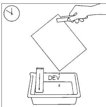
Vérifiez la température dans la cuvette de révélateur ( $20^{\circ}\text{C}$ ) et mettez le chrono à zéro. Glissez la feuille délicatement et rapidement dans le révélateur en vous assurant qu'il n'y a pas de bulles d'air du côté brillant. Démarrez le chrono. Balancez la cuvette d'avant en arrière, de façon continue pour répartir le bain uniformément sur toute l'épreuve. Après 50 secondes, retirez l'image avec une pince et laissez-la s'égoutter.
