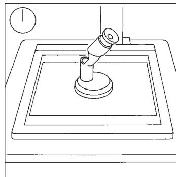
L'objectif étant ouvert à fond allumez l'agrandisseur. Placez une feuille de papier sur le margeur, déplacez la tête pour le cadrage et effectuez la mise au point. Vous pouvez utiliser un vérificateur de netteté, placé au centre de l'image, il permet de faire la mise au point sur le grain du négatif pour une netteté maximale.
