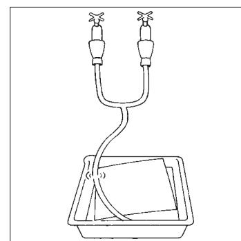
Lavez l'épreuve pendant deux minutes en eau courante de préférence à environ 20°C, une eau froide, au-dessus de 5°C permet aussi un lavage efficace. Videz plusieurs fois la cuvette pour assurer un renouvellement complet de l'eau de lavage ou bien utilisez un tuyau de caoutchouc pour siphonner l'eau depuis le fond de la cuve.
