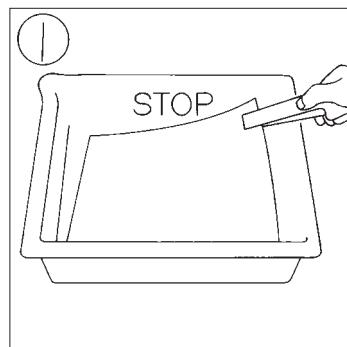
Lorsque le chrono indique 1 minute, introduisez rapidement la feuille de papier développée dans le bain d'arrêt. Prenez garde de ne pas contaminer les pinces du révélateur avec le bain d'arrêt. Balancez la cuvette pendant 30 secondes. Avec la seconde paire de pinces (celle du fixateur) retirez l'épreuve et transférez-la, après égouttage, vers la cuvette de ILFORD RAPID FIXER. (La durée de cette étape n'est pas critique).
