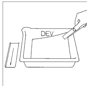
Répétez les étapes 8 à 10 du traitement, comme précédemment. Vérifiez la température du révélateur et respectez la durée de développement. Si le révélateur s'est refroidi de plus de deux degrés, réchauffez-le en le transvasant dans une éprouvette de 600 ml que vous placerez au bain-marie. (La température du bain d'arrêt et celle du fixateur sont moins critiques).
