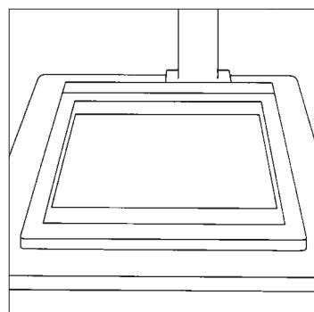
Eteignez la lumière, et sous éclairage inactinique, déplacez le margeur sous l'agrandisseur afin de cadrer l'image comme vous le souhaitez. Prenez une nouvelle feuille de papier MULTIGRADE et placez-la sur le margeur. A l'aide du compte-pose, exposez le papier selon les paramètres corrects déterminés lors de l'essai.
