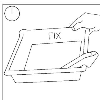
Glissez le papier dans la cuvette de fixateur et balancez la cuvette pour favoriser une bonne circulation du bain à la surface de l'épreuve. Le fixage prend 30 secondes dans une solution fraîche. Il n'est pas grave de dépasser légèrement cette durée mais les épreuves ne doivent pas rester plusieurs minutes dans le fixateur. Si vous ne lavez pas le tirage immédiatement, laissez-le en attente dans une cuvette d'eau propre.
