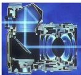
Principe de la visée reflex à 1 objectif (coupe)
