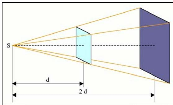
Et maintenant, en avant pour le calcul dans le cas le plus général ! Montrer que l'éclairement d'une surface  $dS$ , placée à une distance  $r$  d'une source lumineuse ponctuelle  $P$  d'intensité uniforme  $I$ , varie en raison inverse du carré de la distance. On appellera  $\alpha$  l'angle supposé constant des rayons lumineux avec la normale à  $dS$ .
