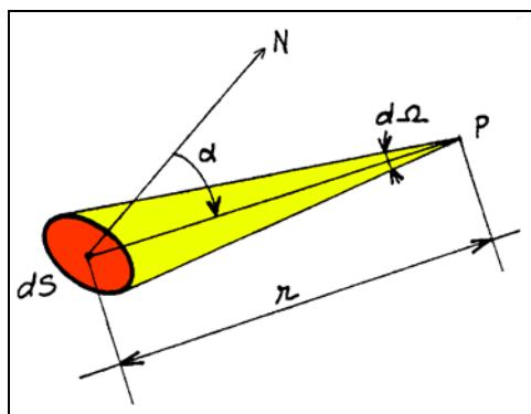
La surface élémentaire  $dS$  étant oblique, il faut calculer l'angle solide  $d\Omega$  à partir de la surface apparente  $dS \cos \alpha$  :
