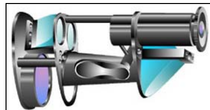
Principe de la lunette de PORRO (doc. Carl ZEISS)
