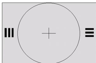
Le pouvoir séparateur est généralement meilleur au centre de l'image que sur les bords, et meilleur dans le sens radial que dans le sens tangentiel. La fermeture du diaphragme améliore les résultats en limitant l'effet des aberrations, puis les dégrade en faisant apparaître de la diffraction.
