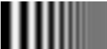
Le contraste est presque inchangé pour les faibles fréquences spatiales mais il diminue au fur et à mesure que les lignes se resserrent jusqu'à donner finalement une plage presque uniforme où l'on ne peut plus distinguer aucun détail.
