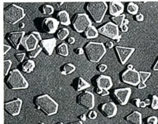
Photomicroscopie électronique montrant les cristaux d'une émulsion 400 DELTA
