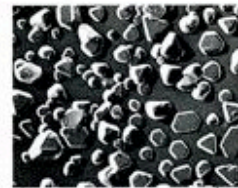
Photomicroscopie électronique montrant les cristaux d'une émulsion conventionnelle
