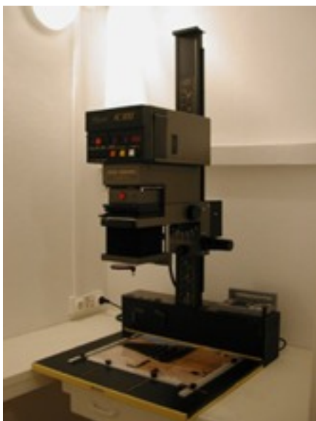
Agrandisseur automatique 4 x 5". 1 Boîte à lumière - 2 Condenseur à focale variable - 3 Logement du porte-négatif - 4 Porte-objectif - 5 Manivelle de montage-démontage - 6 Came de mise au point - 7 Verre anti-couleur - 8 Porte-filtre couleur - 9 Porte-négatif sans verre (Simmon Omega).
