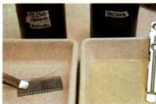
Le renforçateur au chrome permet de blanchir intégralement un film trop dense ; il faut ensuite le redévelopper dans un révélateur universel utilisé d'ordinaire pour les papiers.
