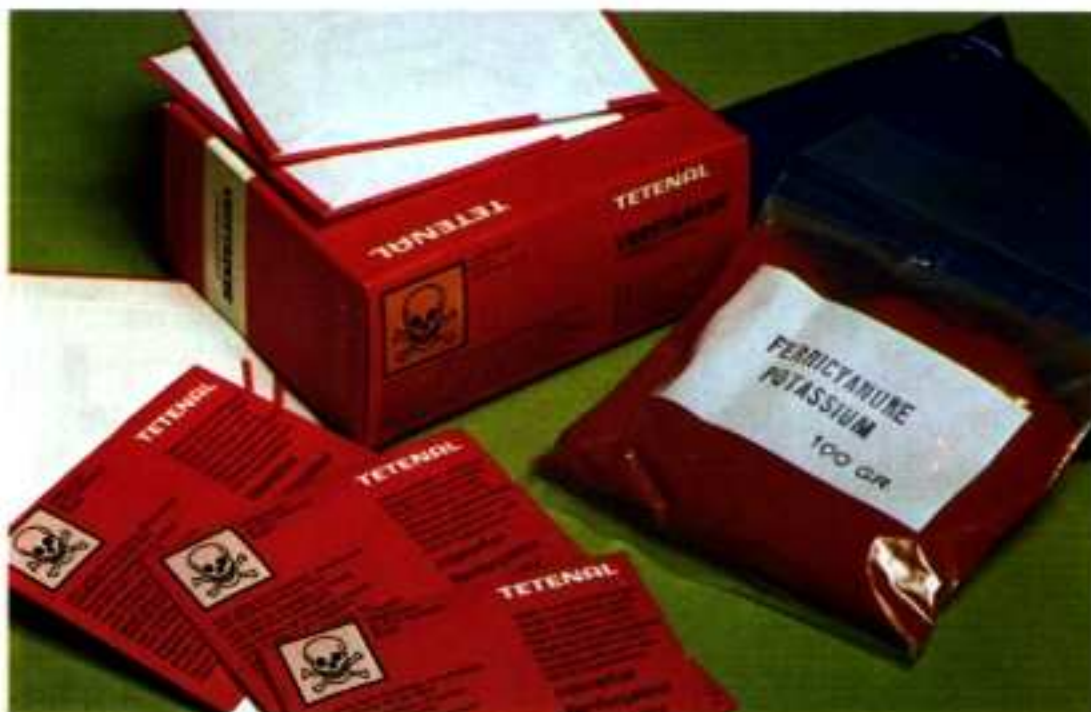
Le ferricyanure de potassium (rouge) ou le persulfate d'ammonium permettent d'affaiblir la densité d'un négatif surdéveloppé ou surexposé. Un négatif trop clair se traite avec un renforçateur au chrome ou à l'uranium (produits toxiques).
