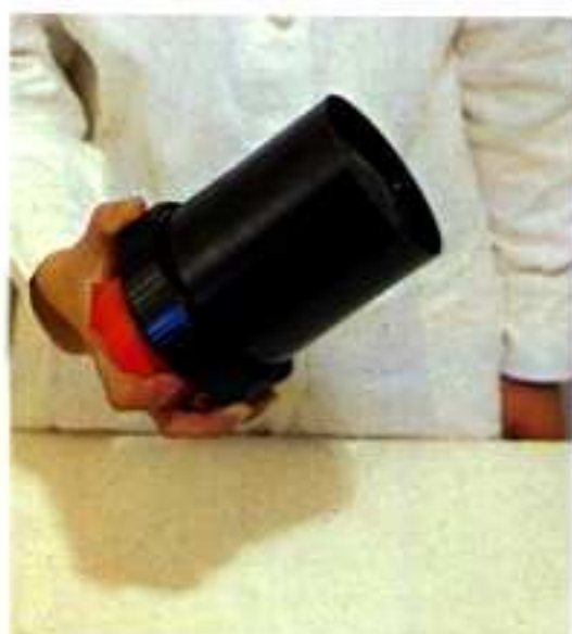
13) Agitez vigoureusement en basculant le haut de la cuve vers le bas.
