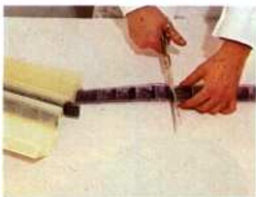
27) Débiter le négatif six vues par six vues et ranger ces petits bouts dans des étuis de papier cristal.
