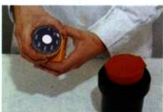
11) et 12) Fermer la cuve hermétiquement... ...démarrer le timer et agiter.
