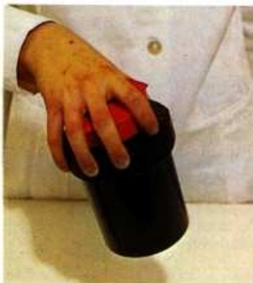
13) Agitez vigoureusement en basculant le haut de la cuve vers le bas.
