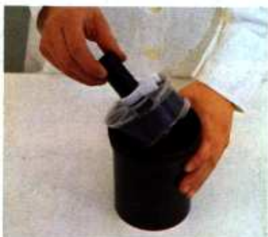
9) Introduire dans la cuve la spirale bien bloquée sur son axe et visser le couvercle-entonnoir bien à fond.
