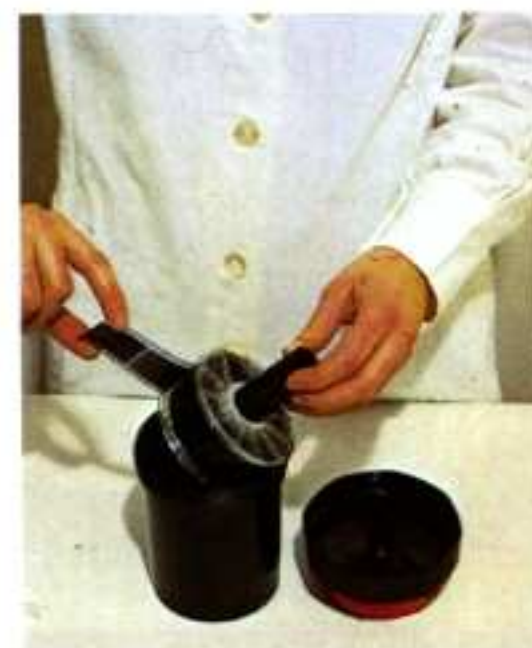
18) Après 4 à 5 mn contrôler la transparence du négatif. Fixer encore 2 mn.
